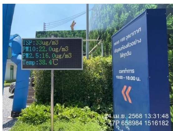
ภาพที่ 27 เครื่องเตือนฝุ่นละอองขนาดไม่เกิน 2.5 ไมครอน (PM2.5) แบบ Real Time
